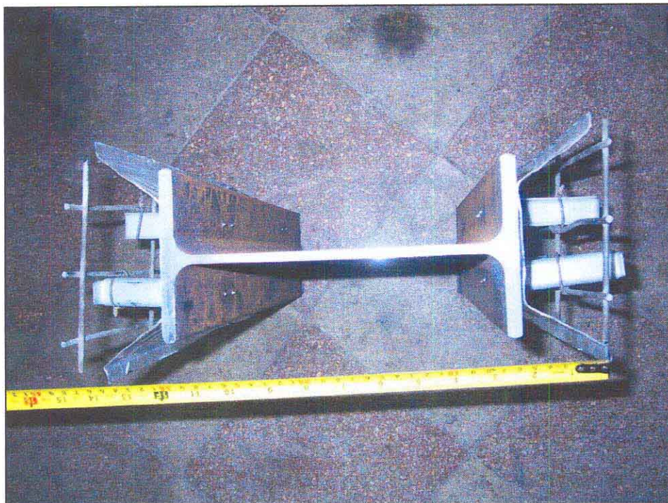
Foto 2. Vista superior de la probeta ensayada antes de hormigonar.
