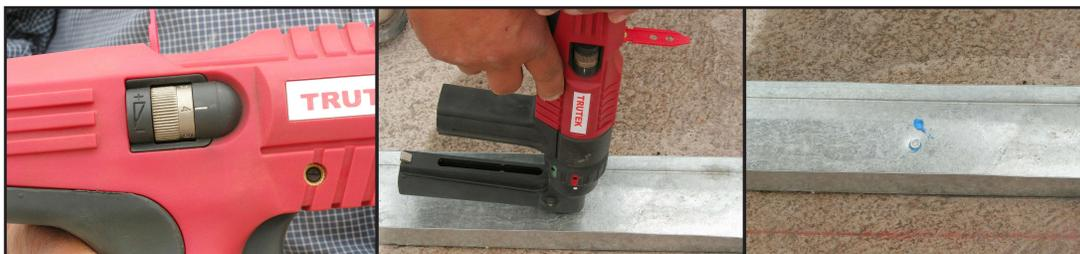
Seleccione potencia asignada, dependiendo de la dureza del material base.
