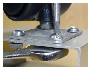
3- Siga atornillando la tuerca con la llave adecuada.
