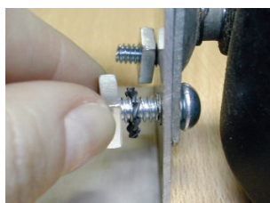
2- Coloque el perno y atornille manualmente la tuerca.
