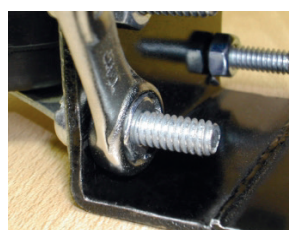
3- Siga atornillando la tuerca con la llave adecuada.
