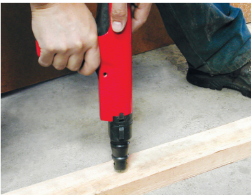
3- Apoye la pistola perpendicular al elemento a fijar, presione y accione el gatillo, percutor.
